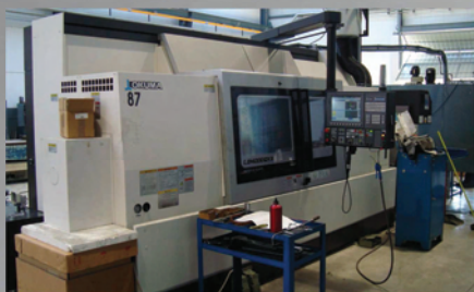
Torn de control numèric OKUMA LB4000 EX II Capacitat de treball: Volteig de 480 i 1500 de longitud
