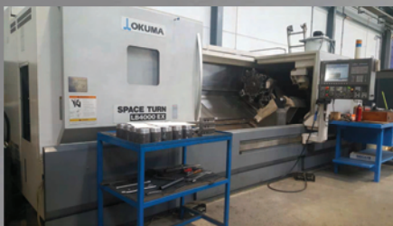
Torn de control numèric OKUMA LB4000 EX Capacitat de treball: Volteig de 480 i 2000 de longitud
