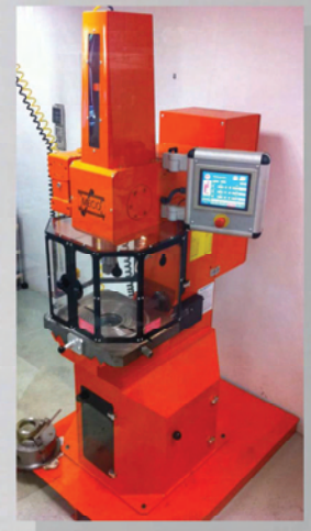
Mortajadora CNC de Ø800x440 Carrera regulable de 0 a 400mm Ancho de chaveta de 3 a 100 mm
