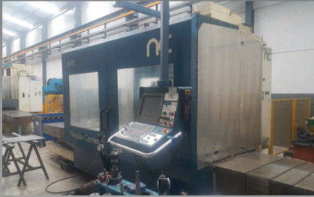
Fresadora CORREA A 30-50 (5000 x1500 x1500)
