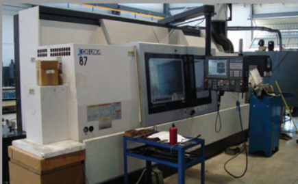
Torno de control numérico OKUMA LB4000 EX II Capacidad de trabajo: Volteo de 480 y 1500 de longitud
