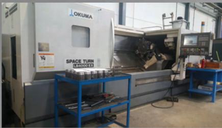
Torno de control numérico OKUMA LB4000 EX Capacidad de trabajo: Volteo de 480 y 2000 de longitud
